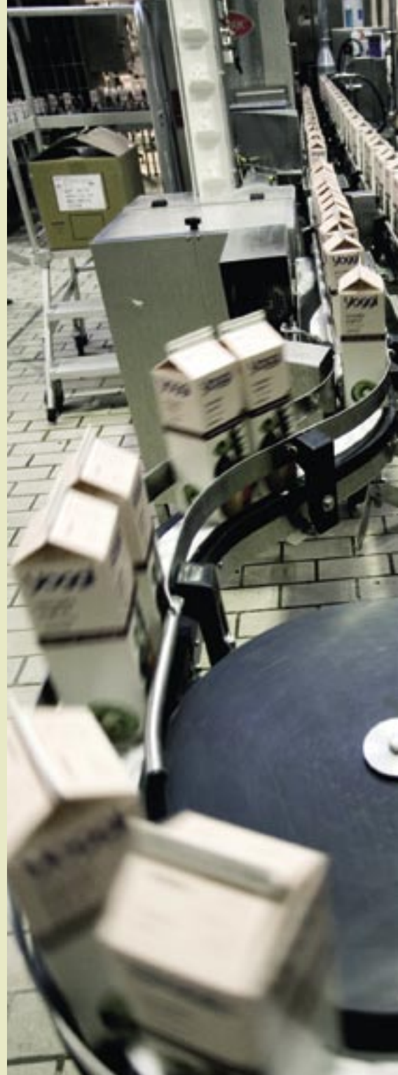
En af dagens Yoggi-produktioner på vej gennem tappelinjen. På et gennemsnitligt arbejdsdøgn i treholdsskift afvikles op
