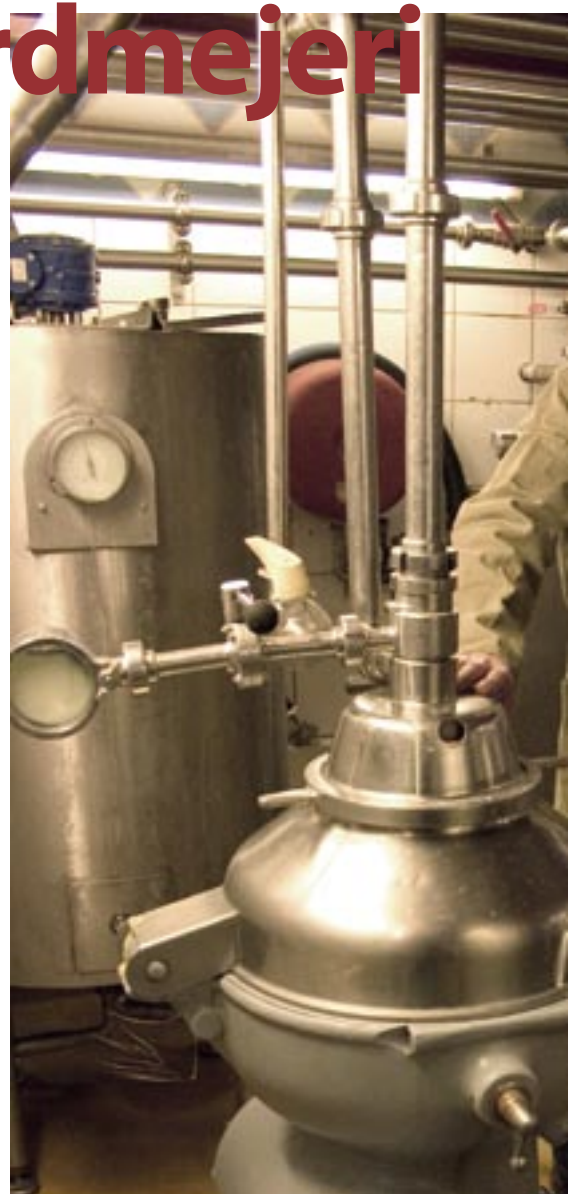
Mejeribestyrer Morten Krohn med hånden på 'hjerteret' i produktionen på Øllingegaard Mejeri: En omkring 40 år gammel Titan centrifuge.
