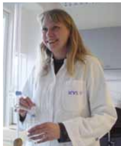
Marianne Jakobsen måler ostens CO 2 -indhold ved hjælp af en såkaldt titreringsmetode: Glasset i hendes venstre hånd indeholder den CO 2 , der er drevet ud af osten, og et indikatorstof. Fra røret tilsættes en 'titrant', som får indikatorstoffet til at reagere med en farve, som fortæller hvor meget CO 2 , der er opløst i ostemassen.
