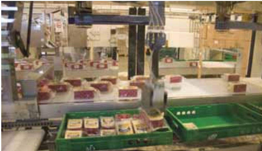
Fart på. Et par utrættelige robotter i gang med at lægge detailpakkede Riberhus-oste i kasser. I løbet af otte sekunder er kassen fyldt op med i alt 12 oste. I realiteten kan robotterne klare opgaven på den halve tid (fire sek.), men skæremaskinen længere henne af båndet kan pt. ikke levere udskårne oste i den hastighed.
